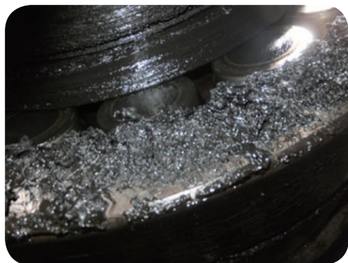
图 1 小牙轮自由端轴承照片
