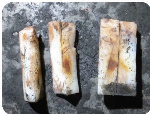
图 3 损坏的尼龙柱销的照片
