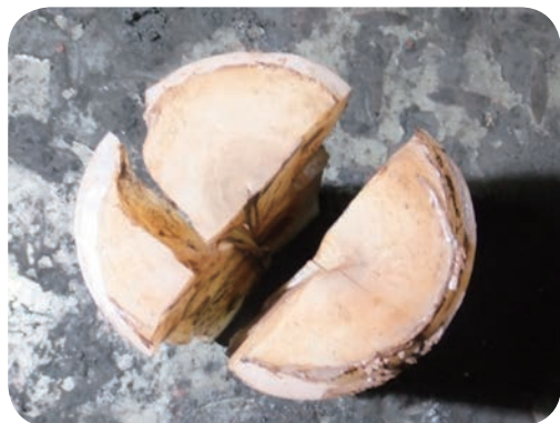
图 3 损坏的尼龙柱销的照片
