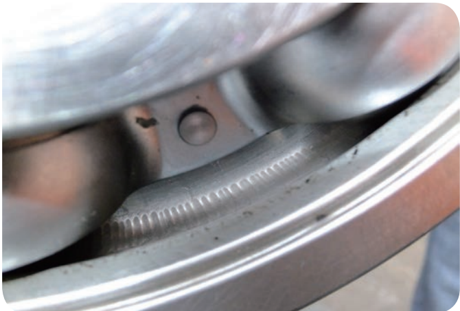
解体电机轴承照片
