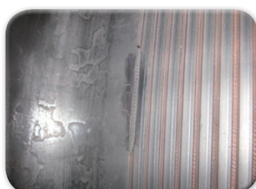
各动静间隙较小 接近发生碰磨等
